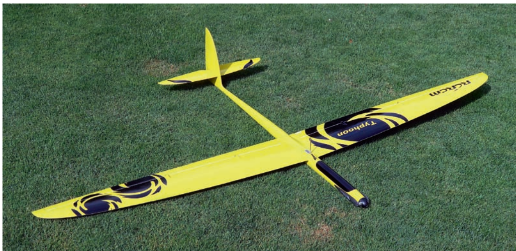
Der „Typhoon“ hat zwei Meter Spannweite und ist ein typischer Allrounder für Hang- und Thermikflug
