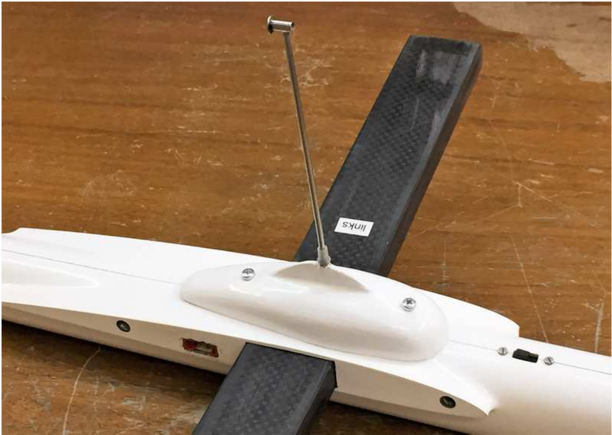
«Piggyback» für den GPS-Logger mit TEK-Düse auf dem engen Rumpf des motorisierten Tanga.
