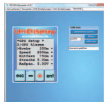
Über den GPS-Konverter lässt sich der GPS-Logger im Uni-Display-Format ansteuern und programmieren. Selbstverständlich stehen dieselben Funktionen auch im mobilen Betrieb mit dem originalen Unidisplay zur Verfügung
