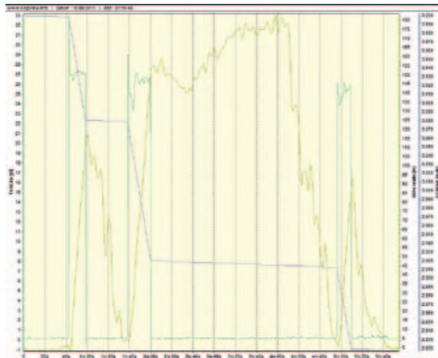
Wird der GPS-Logger mit dem Unilog verbunden, so werden auch alle Daten der dort angeschlossenen Sensoren geloggt. Hier dargestellt sind der aktuelle Strom, der Stromverbrauch und die Flughöhe
