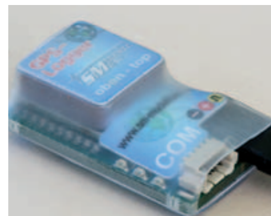
Die GPS-Antenne ist als viereckiges Bauteil auf der Oberseite des GPS-Loggers zu erkennen. Über die COM-Schnittstelle werden entweder das USB-Kabel, das Uni-Display oder aber wahlweise ein Unilog angesteckt
