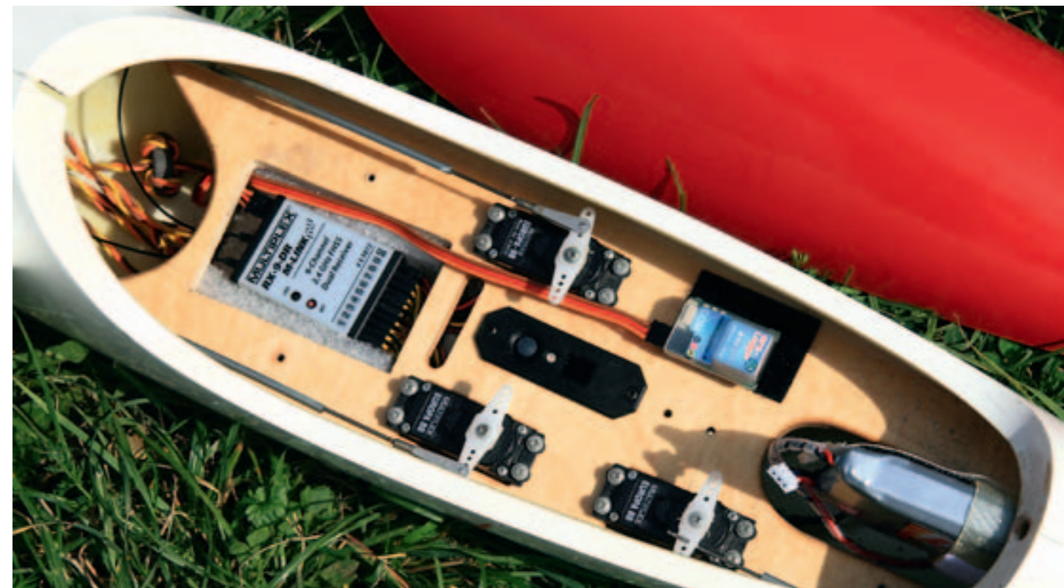
In einem Großsegler verliert sich der Logger fast aufgrund seiner geringen Abmessungen. Befestigt wird er am besten mit Klettband. Wichtig dabei ist, dass die GPS-Antenne nicht durch größere Metall- oder CFK-Bauteile abgeschirmt wird
